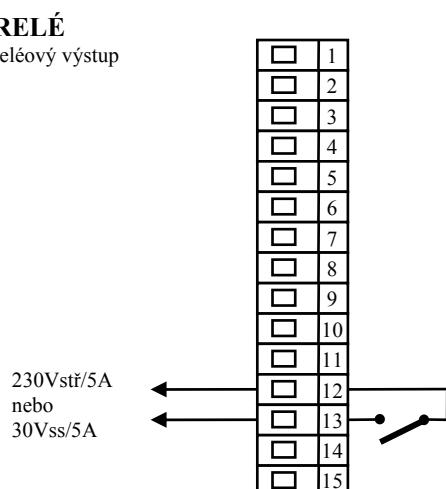
**Výstup RELÉ je galvanicky oddělený od země přístroje.** U tohoto výstupu je nutné vnější vodiče fixovat tak, aby v případě uvolnění vodiče ze svorky nedošlo ke snížení izolace mezi kategoriemi síťového napětí a bezpečného napětí.
