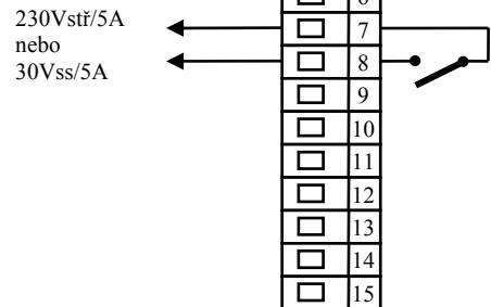
Výstup RELÉ je galvanicky oddělený od země přístroje. U tohoto výstupu je nutné vnější vodiče fixovat tak, aby v případě uvolnění vodiče ze svorky nedošlo ke snížení izolace mezi kategoriemi síťového napětí a bezpečného napětí.
